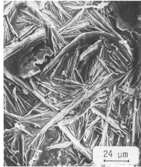
Fig. 6. Aspect en microscopie à balayage de la surface d'un échantillon phosphaté au zinc pendant 60 s et post-traité par K_2PO_3F pendant 60 s.
