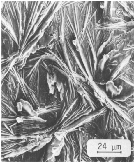
Fig. 5. Aspect en microscopie à balayage de la surface d'un échantillon phosphaté au zinc pendant 60 s.
